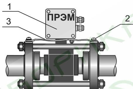
1 – электронный блок; 2 – винт М5; 3 – выравнивающий токопровод
