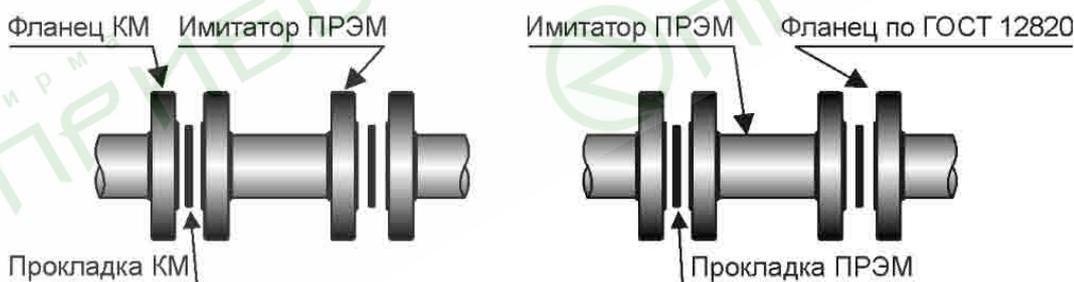
Рисунок 10 – Варианты установки габаритного имитатора ПРЭМ
