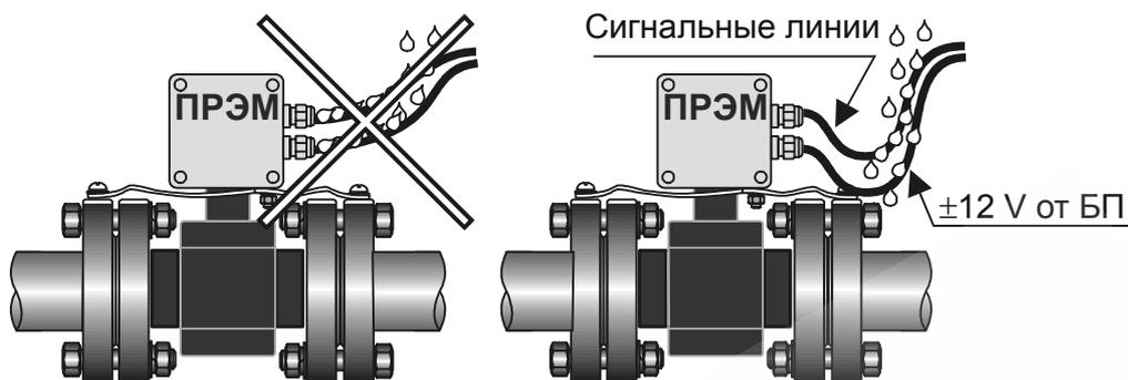
**ВНИМАНИЕ!** По окончании монтажа необходимо с помощью омметра убедиться в отсутствии замыкания сигнальных линий и линий питания на трубопровод!
