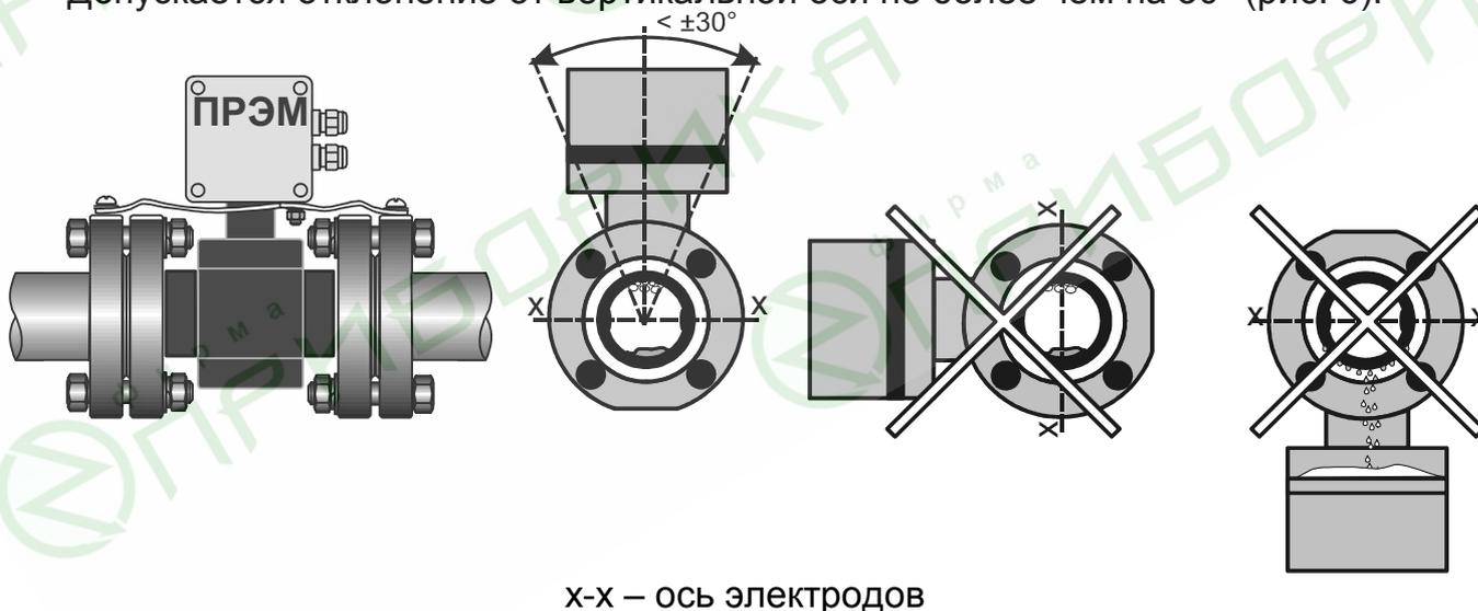
Рисунок 6 – Установка на горизонтальных каналах
