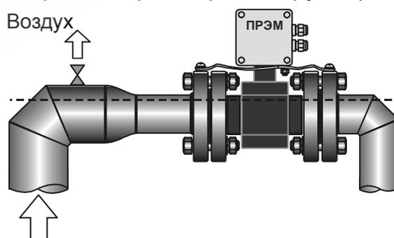
Рисунок 3 – Установка ПРЭМ в верхней точке трубопровода
