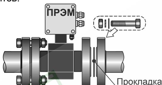
Рисунок 13 – Варианты монтажа ПРЭМ фланцевого исполнения
