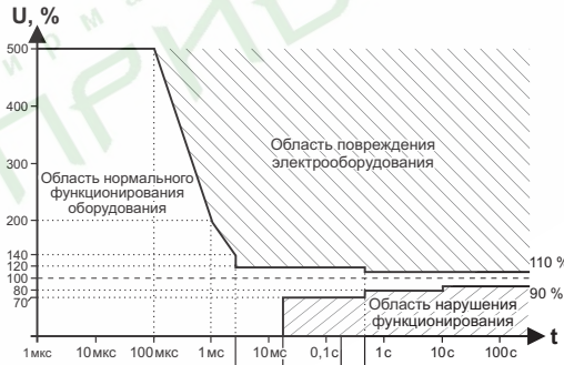
Рис. 1. Кривая работы электрооборудования ITIC (CBEMA), ( http://www.home.agilent.com/upload/cmc_upload/All/1.pdf?&cc=UA&lc=eng ).
