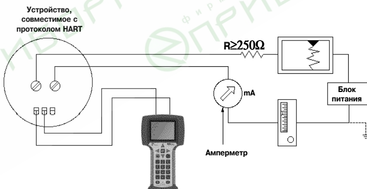
Рисунок 3-3 Непосредственное подключение к устройству HART
