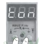
При включении устройство сразу начинает отображать значение напряжения сети. Если напряжение находится в допустимых пределах, включается нагрузка, и начинает светиться зеленый светодиод. Если напряжение сети превышает верхний предел или ниже нижнего предела, тогда напряжение на нагрузку не подается.
